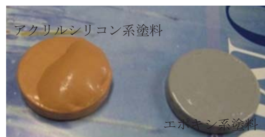
図3 長期間の水蒸気接触による塗料被覆セメントペレットの膨潤の様子
