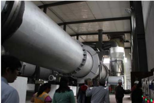
図 10 モンゴル Shivee-Ovoo 炭鉱に導入された褐炭乾燥設備
