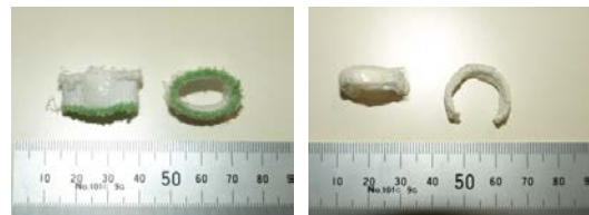
図2 開発した布バンド(左)と、布を巻いた半円形の指輪(右)の固定方法
