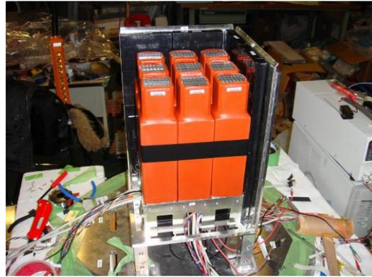
路で処理されて、パルスハイトがデジタル的に出力されるようになっている。また検出器の上には視野を限定するためのコリメーターが設置されており、側面は周りからのバックグラウンドを低減するために、パッシブシールドが配置されている。我々は2006年に製作したユニットカウンタを一度全て分解し、よりパッシブシールドを強化したユニットカウンタを8台作り、これを組み立てた。またカニ星雲からのフラックスを計測するためのフラックスモニター(モニタカウンタと呼ぶ)を取り付けて、上の写真の様な検出器を最終的に製作した。そして、以下の写真に示されている様な荷姿を作って、2009年6月13日に北海道大樹町から放球した。
