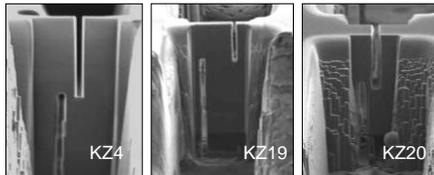
図1 作製した超伝導多重接合素子
