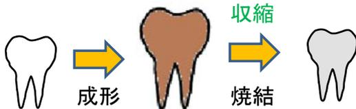
図 2 型どり工程の途中で樹脂型を膨張させ、大きな成形体を得て焼結収縮を保障する
