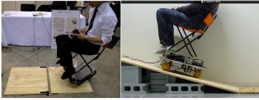
図4：提案する球駆動式全方向移動機構 左：18mmの段差乗り越えの様子 右：18度の登坂の様子
