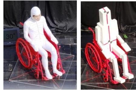
図1-2 日射受熱面積測定で得られた写像例 (左：車いす乗車人体 右：人体直方体モデル)
