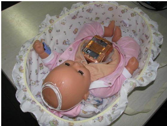
図4 赤ちゃん型ロボットへの 人体通信送信ユニットの実装
