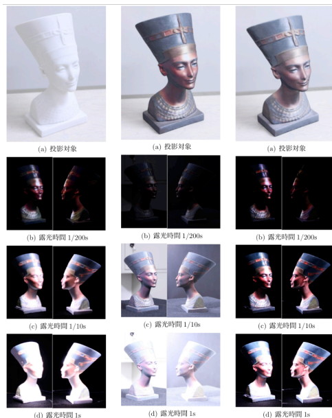
図8：HDR表示結果（左から、白色模型にテクスチャ投影、同様環境光下に置いた3Dプリンタ出力、提案手法）
