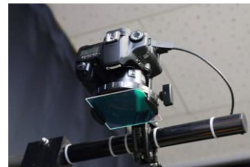
図2. 計測系に取り付けられたマルチバンドカメラシステム(カメラ+光学フィルタ)
