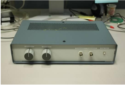
写真 2. 開発した蛍光測定装置の信号発生装置。
