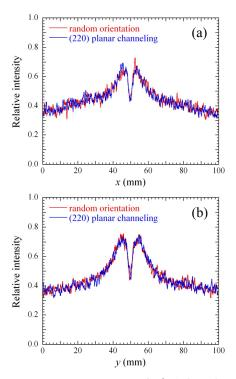
図9 図8に示したPXRの角度分布の中心部を通る断面図。(a)水平方向、(b)鉛直方向。赤線はランダム入射条件(非チャネリング条件)、青線は(220)面チャネリング条件時のデータを示す。
