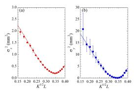
図 4 Qスキャン法の測定結果。(a)水平方向 と(b)鉛直方向のビームサイズ $\sigma$ の 2 乗。Kは 4 極電磁石の強さを表すK値、Lは磁石長。
