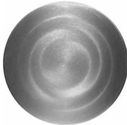
[図5: 鱗片状粒子による流れの可視化。 $Re=8 \times 10^4$ 、 $\Gamma=0.002$ 。室内実験。流れは定常流であり、定常なパターンが可視化される]
