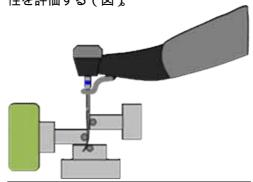
試料には、既存の Ni-Ti ファイルである ProFile (Dentsply Maillerfer, Switzerland)の先端径 0 . 3 0 mm、 0 . 0 6 テーパーの者を使用した。荷重点間距離は 5 mmとし、ファイル先端 2 mmに位置した 円柱形冶具を水平方向に移動させることにより、ファイルの曲率を規定した。また、中
