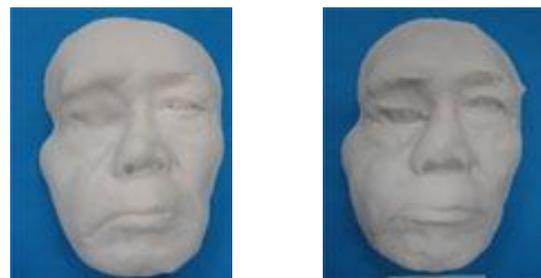
(4)これらの模型をさらに RexcanIIIにて表面形状計測し、Geomagics studio/qualify を用いて重ね合わせを行い、さらに表面形状・精度の評価を行った。データ上の重ね合わせ同様、深い
