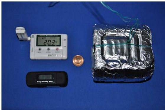
図1、気象センサー付きデータロガー（左上）、液晶表示付きGPSデータロガー（左下）、日射よけ覆い（右）である。
