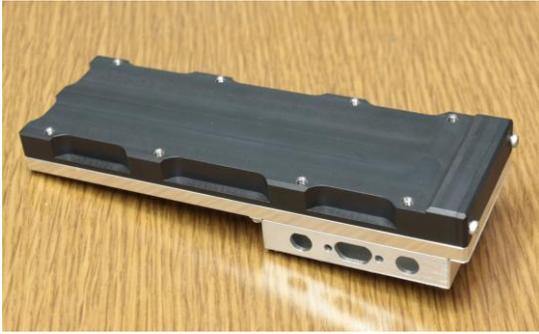
図 6：エンジニアリングモデル管体（フライト時にはプラスチック部を電磁シールドで遮蔽）。シンチレータ支持部はスーパーエンジニアリングプラスチック製、ベースには肉抜きしたアルミニウム合金を使用し、シールド材を含めた質量を 260g 以下に抑えている。
