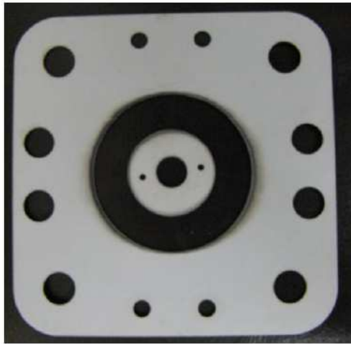
図4 推進機前面の絶縁体によカバー
