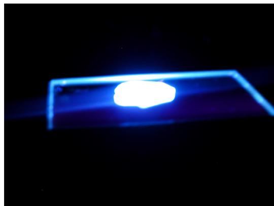
図4 Rにフェニルエタンを用いた結晶が蛍光を発する様子。
