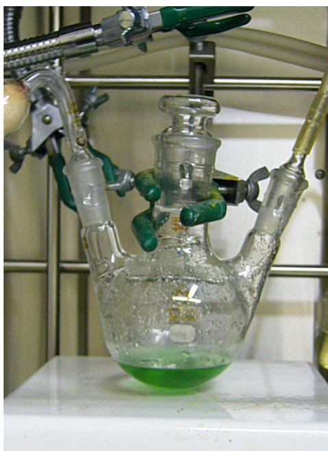
図3 有機無機層状ペロブスカイト型化合物の合成の様子. 溶液の着色は二価金属のドーピングによる。
