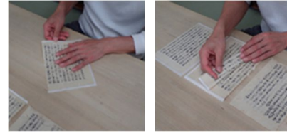
図4 補填後の疑似本紙における 修理技術者による補填紙接着 性の評価
