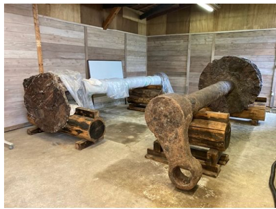
Fig 7. 順動丸シャフト 表面処理後（右側）
