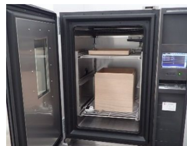
写真2. 桐箱の温度処理実験の様子
