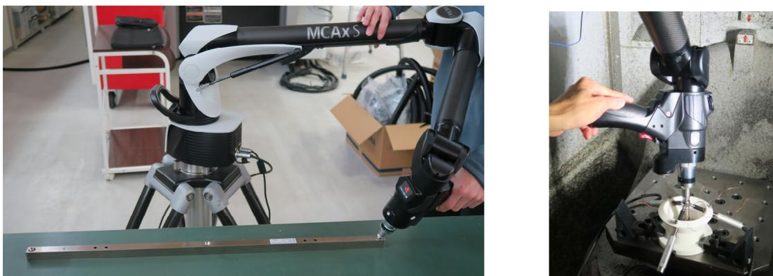
図 6 アーム型 3 次元測定機の測定精度評価実験とモデル同定実験の様子
