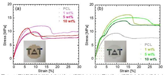
図 3:(a)同時酵素糖化粉砕由来リグニン誘導体または(b)同リグニン誘導体白色物を複合した PCL 熱混錬物フィルムにおける引張応力 - 歪特性およびフィルム写真。白色リグニンの配合に より、意匠性を損なわず未処理の同時酵素糖化粉砕由来リグニン誘導体に比して高い PCL の剛 性向上が確認される。
