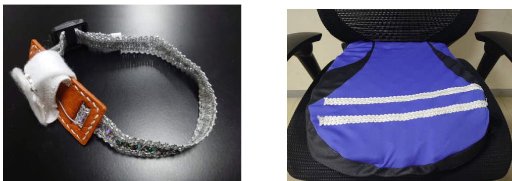
Figure 1. (左図) FPS センサーの形状、 (右図) クッションに埋め込まれた状態
