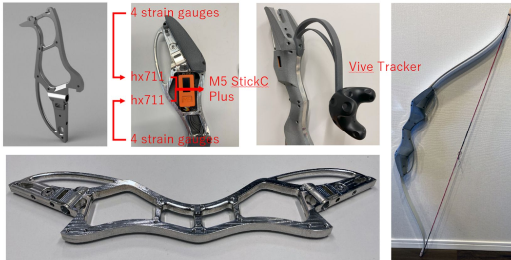
図4: 弓型 UI デバイスのグリップの構造。改良した2分割のグリップ（左上）
