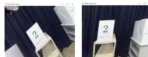
図 6 カメラを傾けたときの切り出し画像。左：安定化なし、右：安定化あり。
