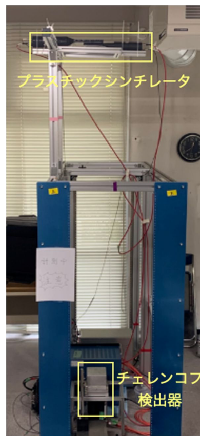
図2 宇宙線を用いた TOF・チェレンコフ光量相関測定のセットアップ
