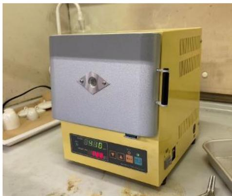
図3 卓上型電気炉
