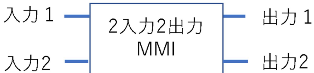
図 8 : 多モード干渉導波路 MMI (Multi-Mode Interferometer) 。2つの入力光を干渉させ、出力 1 と 2 の間に 90 度の位相差を持たせるものである。
