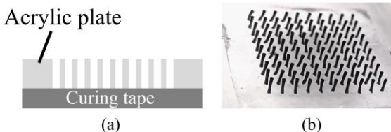
図 3 ミリメートルスケールの磁性粒子分散柔軟ピラー群。
