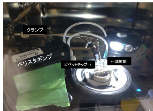
図 2 軸索への選択的薬理刺激のための薬理刺激システムの概要と実験時の様子を示す。薬液を保持する inlet には 200 \mu\text{l} のピペットチップの先端に外径 2 mm、内径 1.5 mm のシリコンチューブを接続し、プラズマ処理を行ったものを用いた。outlet には注射針を挿し、ペリスタポンプで 20 \mu\text{l}/\text{min} で 90 秒間吸引した。薬液が流路内に送られていることは inlet の液面の高さの変化で確認した。薬液の交換はクランプで保持したピペットチップを外し、別の液体で満たされたピペットチップに付け替えることで行った。薬液としてナトリウムイオンチャネルブロッカーである TTX を 5 nM、10 nM、100 nM の 3 つの濃度で用いた。
