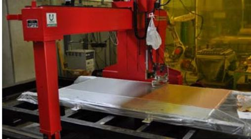
図7 幾何学的粗度製造装置
