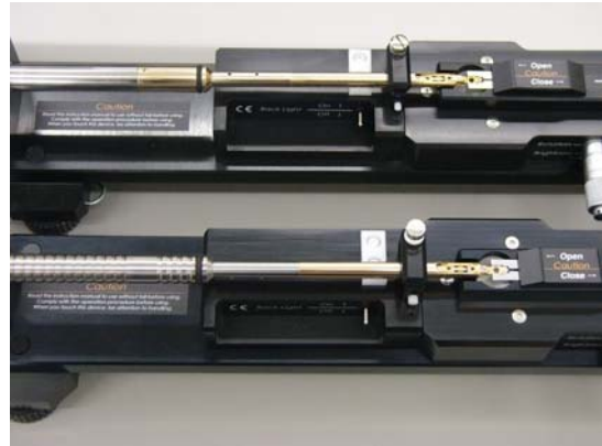
図3. 試料ホルダーフレーム部. 従来開発品(上)と本研究開発品(下). 熱膨張係数の小さい重金属合金部材(ホルダーフレームの銀色部)を用いるとともに、熱伝達性能を高めるためのらせん状くぼみ加工を施した。
