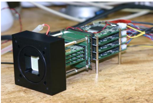
図5 シンチレータアレイと超高感度ピクセル型光検出器を組み合わせたシステムの外観
