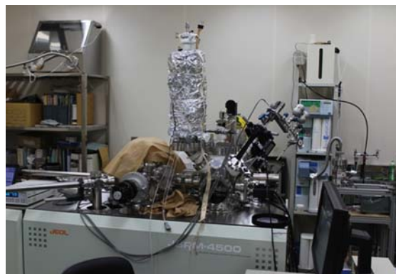
図 1 極低温超高真空原子間力顕微鏡
