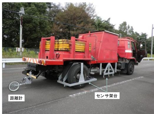
図-2 試作した連続式たわみ測定装置
