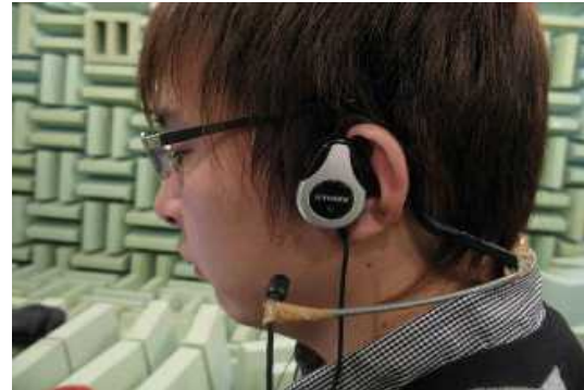
図 3 : 骨伝導アクチュエータ (周波数特性計測のための実験の様子)
