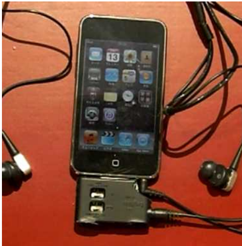
図 1 : iPodTouch に実装した両耳補聴システムのプロトタイプ
