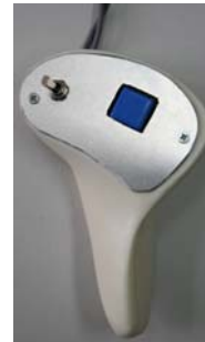
図 5 製作した筋ジストロフィー疾患患者専用の制御コントローラ。右側のプッシュスイッチは制御入力スイッチ、左側のトグルスイッチは緊急停止スイッチである。
