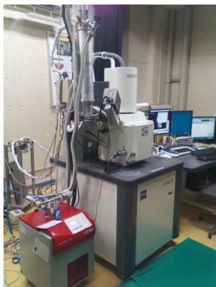
図2.九州大学に設置してある、TES型マイクロカロリメータEDSを装備した走査型電子顕微鏡(SEM)の外観。
