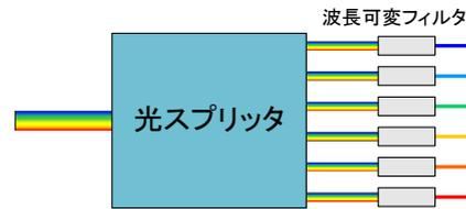
図22 FLC装荷Siグレーティング導波路と光スプリッタを集積化した波長可変フィルタアレイ
