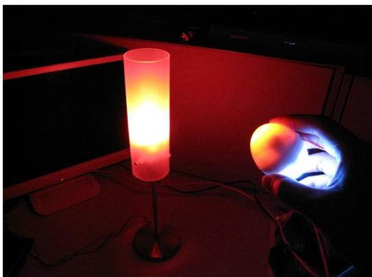
図7. SyncEgg : 卵型インタフェースで照明装置を制御するシステム
