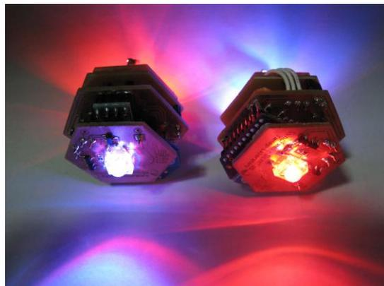
図3. 遠隔非言語コミュニケーションシステムを制御する通信モジュールの電子基板
