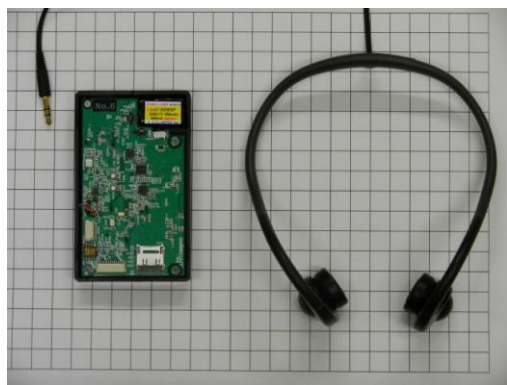
図3 開発した泳加減速聴覚フィードバックシステム。慣性センサを搭載したロガー部(図中左)と防水型骨伝導ヘッドフォン(図中右)により構成される。
