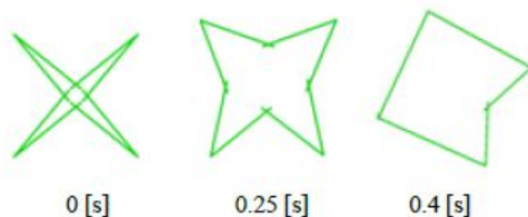
図3 簡易梁モデルによるセイル膜展開挙動の再現と評価[c2]
