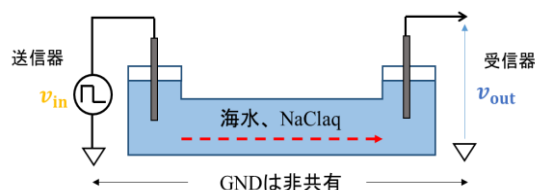
図 4 単純な受信電極での塩水管あるいは塩水路での通信の概要図
