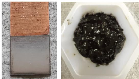
Fig. 4 (左) めっき物外観および(右)分離操作により得られた銀成分の黑色沈殿
