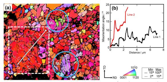
**図 4** 透過 EBSD により得た圧延まま材の表層近傍の(a) IPF マップおよび(b) Line 1 および Line 2 に沿って得た方位差プロファイル (1)
