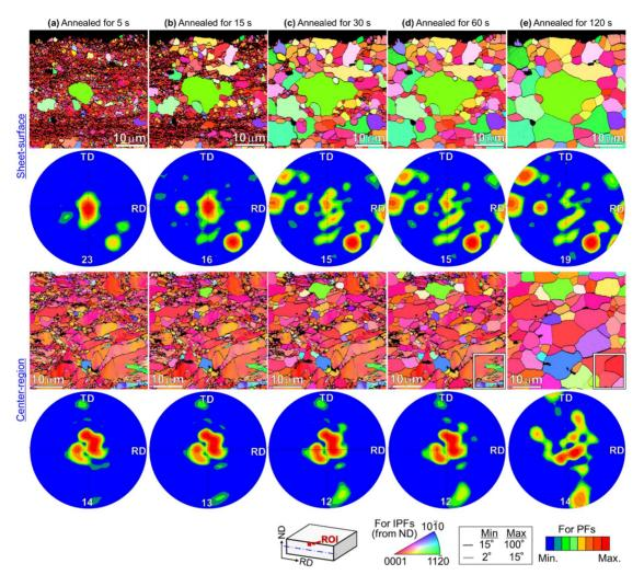
**図3 図2(a)**中の白枠領域( 表層近傍、 中央部)の EBSD 同視野観察により得た IPF マップと(0001)極点図<sup>(1)</sup>
