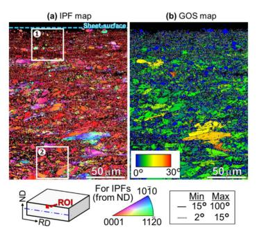
**図2** 圧延まま材の(a) IPF マップおよび (b) Grain Orientation Spread(GOS)マップ<sup>(1)</sup>
