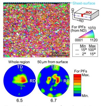
**図1** 最終熱処理後の IPF マップおよび(0001)極点図<sup>(1)</sup>
