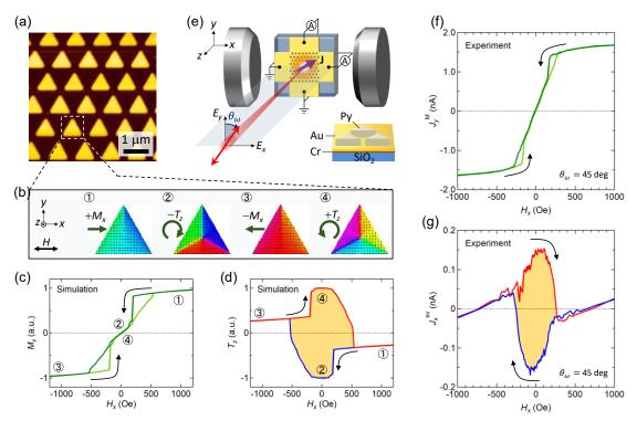
図 2 (a) 作製したパーマロイ ( $Ni_{78}Fe_{22}$ ) ナノ磁性体周期配列の AFM 像。(b)-(d) マイクロマグネティックシミュレーションを用いたナノ磁性体中の磁気状態の見積もり。(b) 磁気状態の空間分布。(c) 一様磁化  $M_x$  の評価。(c) 渦状磁気状態  $T_z$  の評価。(f) 一様磁化に由来する磁気光電変換の外部磁場依存性。(g) 渦状磁気状態に由来する磁気光電変換の外部磁場依存性。
