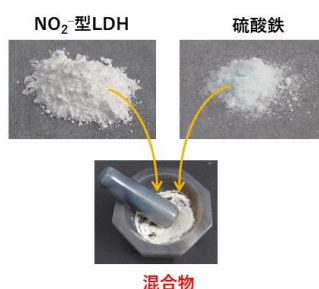
図2. 亜硝酸イオン含有層状複水酸化物を用いた \text{NO} 発生材料
